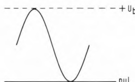
Fig. 1. Bij een enkele voedingspanning beweegt de sinusgolf zich tussen de nul en voedingspanning. Het daardoor beschikbare vermogen is meestal gering.
